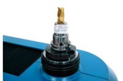
**Impression des étiquettes :** Vous obtenez avec précision, fiabilité et rapidité cinq résultats de mesure de l'arête de l'outil : longueur, diamètre, rayon et angles de coupe 1 et 2.
