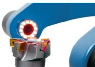
**Éclairage LED longue durée à lumière froide** fourni de série pour l'inspection des arêtes sur les bancs de préréglage.
